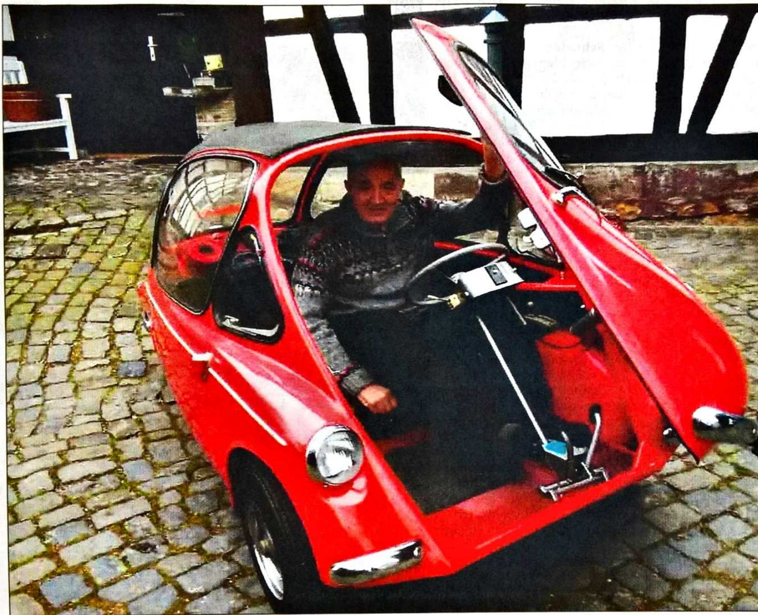
Großer Mann und kleines Auto: Klaus Kutsche neben seiner Heinkel Kabine, Baujahr 1958. Die Knutschkugel der 50er-Jahre holt zehn PS aus 0,2 Litern Hubraum.
